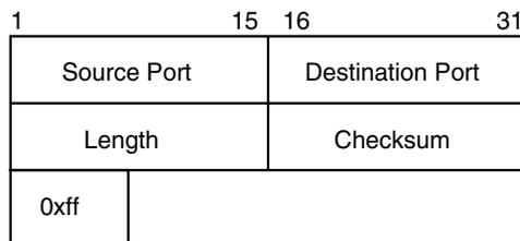
Abbildung 3.14 Der UDP NAT Keepalive Header hält die Verbindung aufrecht, wenn keine Daten transportiert werden müssen
